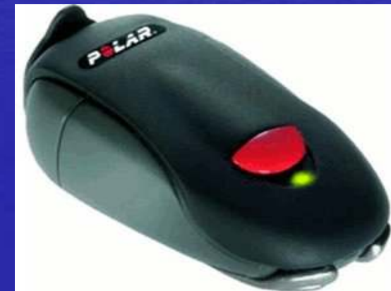
Accéléromètre aux pieds pour enregistrer la distance parcourue lors du test
